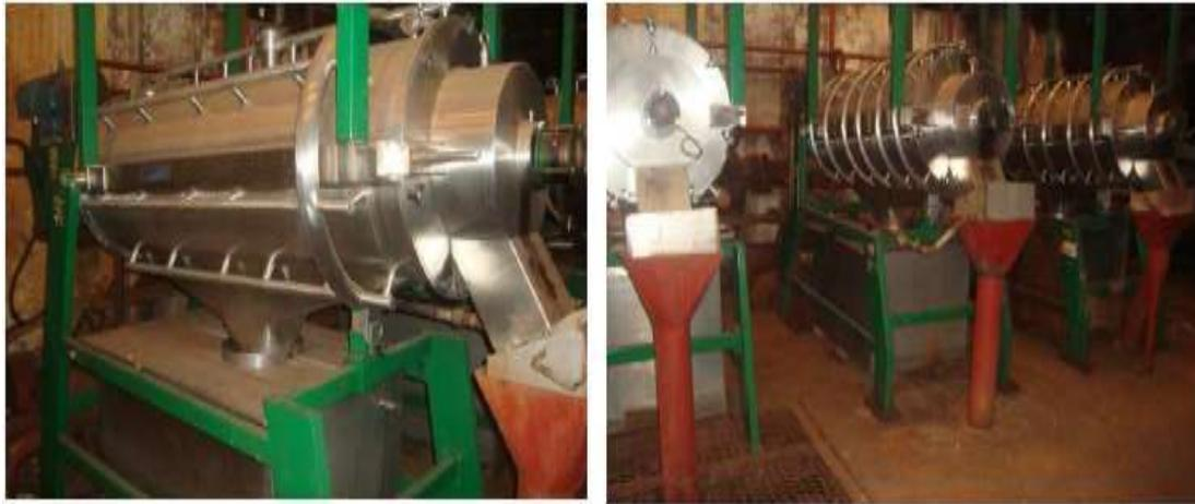
Figura 14. Turbo filtros fábrica
