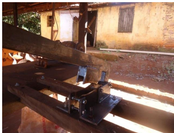
Figura 9. Guilhotina para corte das gemas, na Fazenda Paineiras, 2013.
