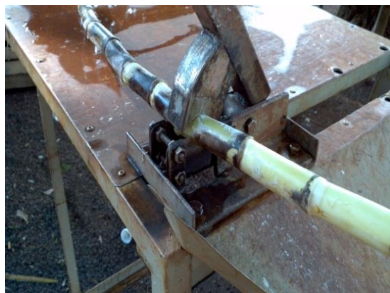
Figura 3. Corte dos minirebolos em Guilhotina
