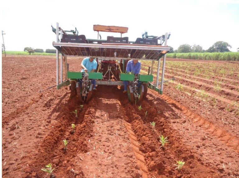
Figura 17. Plantio mecanizado do MPB, espaçamento de 0,50m entre mudas e 1,5m entre linhas na Fazenda Santa Rita, 2013.
