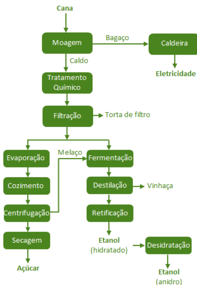
Figura 1. Fluxograma do sistema de produção do setor sucroenergético.
