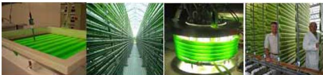
Figura 6. Vários designs de Fotobiorreatores (FBR) usado na indústria. Da esquerda para direita: FBR Caixa Brite (Fonte: Natural Resources Canada); FBR Tubular (Fonte da Imagem: Bioprodukte Prof. Steinberg); FBR Embrulhado (Fonte: The University of Georgia); FBR de Alta Densidade Vertical (Fonte: Vertigro Products, Inc.).
