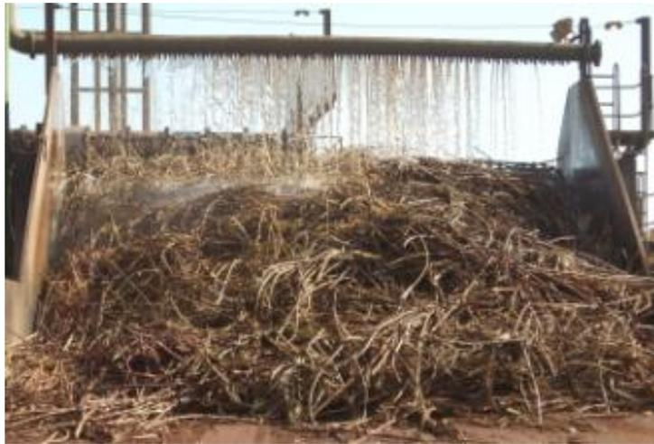
Figura 4. Lavagem da cana-de-açúcar para retirada de impurezas. (Fonte: Embrapa)
