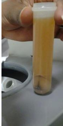
Figura 23: Processo de separação do vinho levedurado por centrifugação. FONTE: PRÓPRIO AUTOR, 2015.
