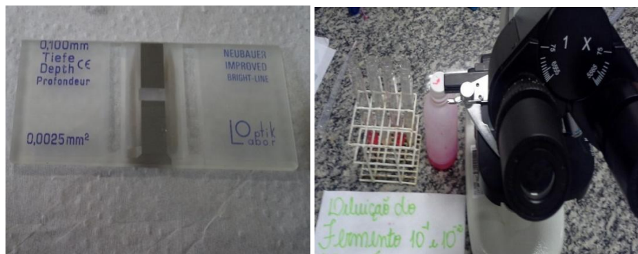
Figura 21: Câmara de Neubauer; Materiais e Equipamento utilizados para visualização das amostras diluídas a 10^{-1} e 10^{-2} .
