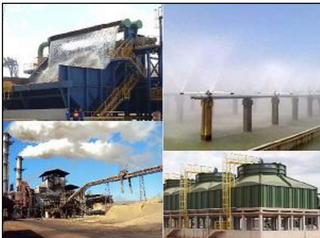
Figura 4- Equipamentos com maior consumo de água nas usinas de açúcar e álcool Fonte: Mesa alimentadora, ISAIAS CUNHA (2015); Resfriamento por aspersão Spray Pond: REPLASS(2014); Caldeira: UTE SantaCândida (2012);Torres de resfriamento: CF ENGENHARIA(2015).
